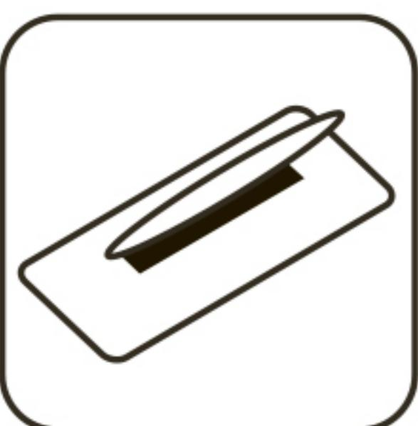
Для достижения наилучших результатов используйте валик и шпатель **"Stream"**. Валиком с длинным ворсом создают объемную структуру материала, а пластиковым шпателем, со слегка скошенной и сточенной кромкой, добиваются окончательного рисунка, характеризующегося участками различной толщины и блеска.
