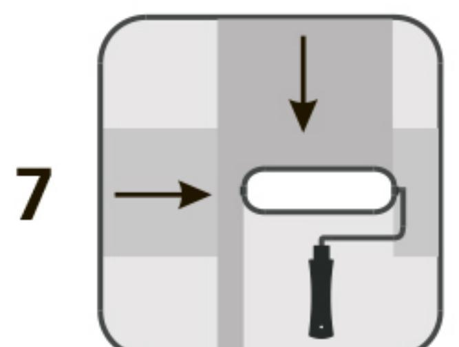
7 Нанесите краску на поверхность в произвольных направлениях. Главная цель данного этапа - добиться равномерного распределения материала. При этом очень важно следить за тем, чтобы на окрашиваемом участке поверхности образовывался довольно толстый слой коллекции **"Stream"**.
