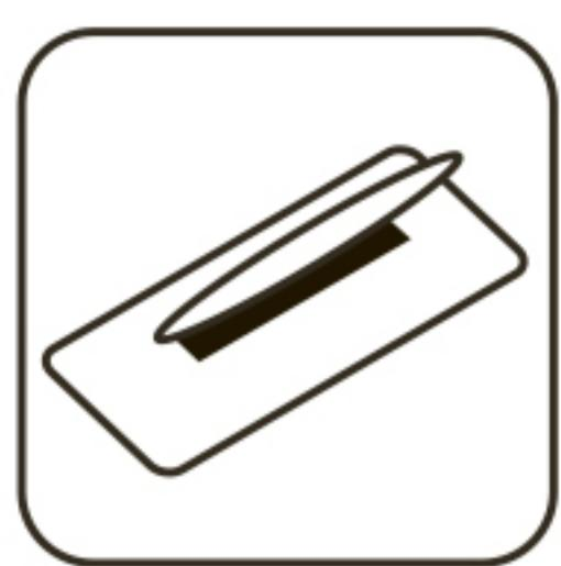
Наносите материал шпателем "**Venicelook - Opus**" из нержавеющей стали. Углы шпателя должны быть закругленными, а края слегка скошенными или сточенными. На протяжении всей работы шпатель необходимо плотно прижимать к стене, держа его под углом 15°-20° к поверхности. Для обработки труднодоступных мест (углов, розеток и т.д.) используйте узкий шпатель из нержавеющей стали. Инструмент рекомендуется периодически очищать от прилипающего материала другим шпателем.
